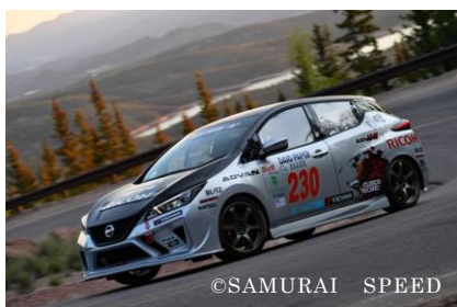
ボンネットや後部ドアに ELLEX-M を採用した実装電気自動車
